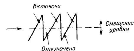
Рис. 8-10. К пояснению регулирования относительной длительности включенного состояния в схеме рис. 8-9.
